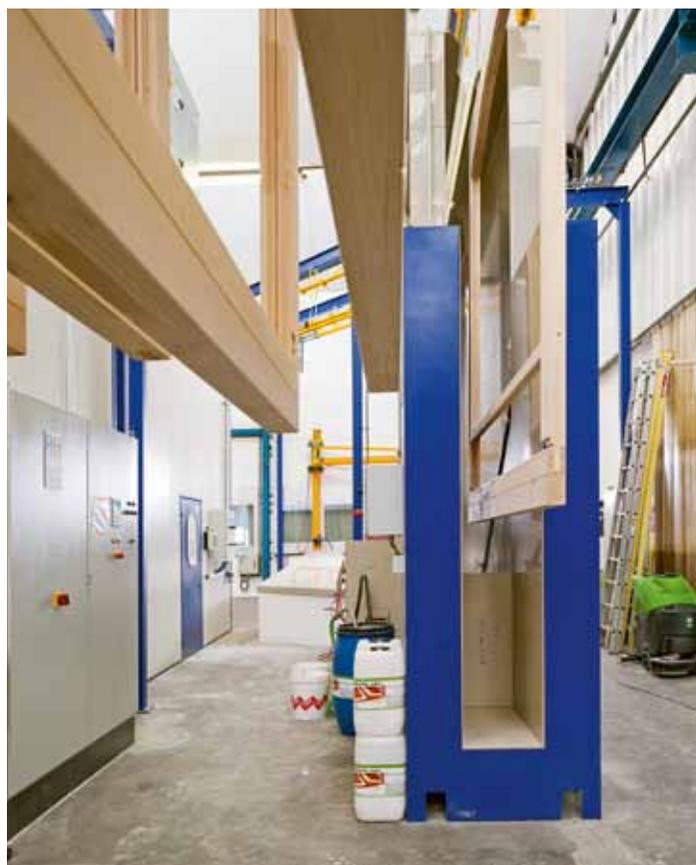
Automatische Fördersysteme transportieren die Fensterteile zu den Beschichtungsanlagen. Hinter der Flutanlage erfolgt die automatische Schräglage zum Abtropfen.
